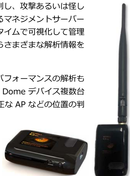
WifiWall Dome 本体 (Wi-Fi 通信検知解析コンピューター)
